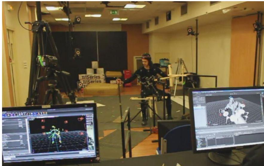
**Fig. 5 - Exemple de placement de cameras en cercle autour de l'acteur (Système Vicon), studio Mocaplab.**
